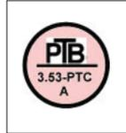
Nach der ATEX-konformen Regelung ist auf dem Motor z. B. folgende zusätzliche Kennzeichnung anzubringen:
