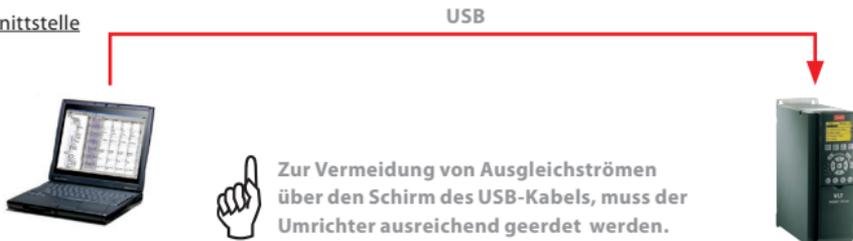
Die Verbindung zwischen Umrichter und PC wird automatisch erkannt. Das Einstellen von Parametern im Umrichter oder in der PC-Software ist nicht notwendig.
