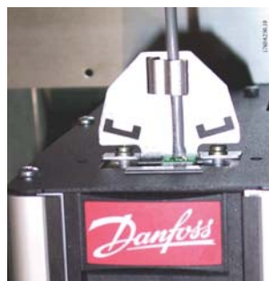
Abbildung 6.36: Anschluss von oben für Feldbus
