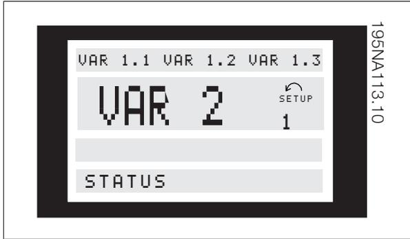
Im Normalbetrieb können nach Wahl dauernd bis zu vier verschiedene Betriebsvariablen angezeigt werden: 1,1, 1,2, 1,3 und 2. Der aktuelle Betriebszustand bzw. Alarm- und Warnzustände werden in Zeile 2 numerisch angezeigt.
