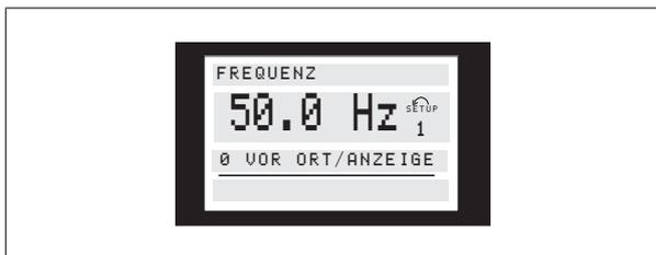
In der 3. Zeile des Displays werden Parametergruppennummer und -name angezeigt.
