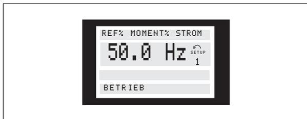
Hier werden die Parameternamen und Einheiten der Betriebsvariablen in der ersten und zweiten Zeile angezeigt. Zeile 2 der Anzeige bleibt unverändert.
