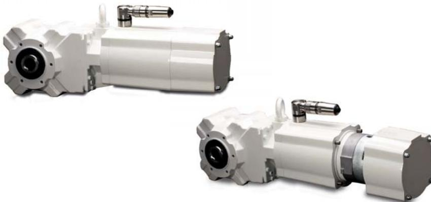
Unter dem Begriff AsepticDrive™ ist ein Asynchronmotor zu verstehen, der in seiner Grundkonzeption ohne Kühlrippen und Lüfter ausgeführt ist. Das Resultat ist ein Motor mit einem vollkommen glatten Außengehäuse, welches durch ein ebenso konzipiertes B-Lagerschild verschlossen ist.
