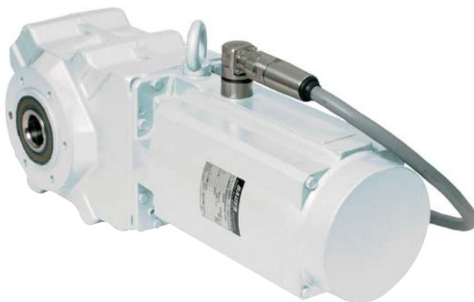
Unter dem Begriff AsepticDrive™ ist ein Asynchronmotor zu verstehen, der in seiner Grundkonzeption ohne Kühlrippen und Lüfter ausgeführt ist. Das Resultat ist ein Motor mit einem vollkommen glatten Außengehäuse, welches durch ein ebenso konzipiertes B-Lagerschild verschlossen ist.
