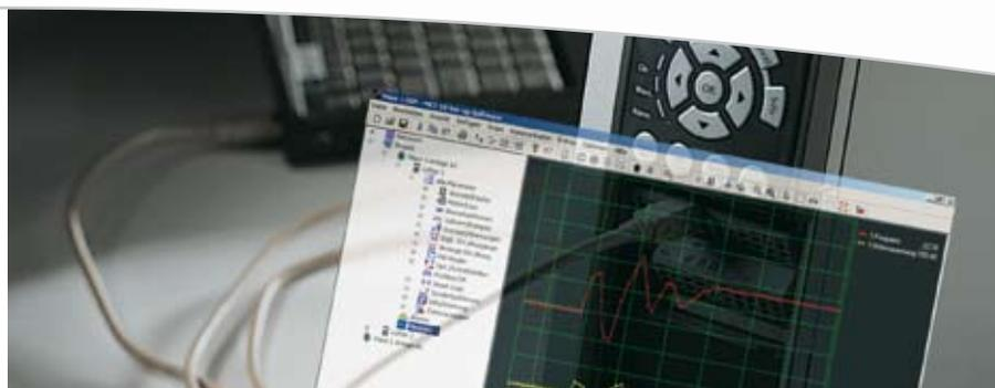
*Die anlagenorientierte Software MCT 10 erlaubt die schnelle und einfache Konfiguration - auch bei einer großen Zahl von Antrieben.*
