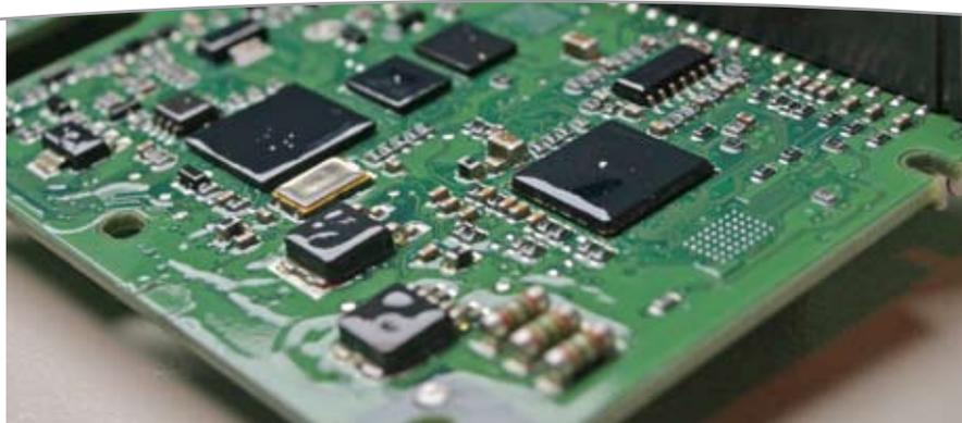
Für besonders raue Umgebungen, beispielsweise in Chemieanlagen oder Klärwerken, sind die Platinen auch in einer lackierten Ausführung verfügbar.
