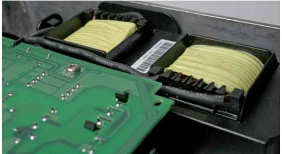
*Eingebaute Zwischenkreisdrosseln reduzieren die niederfrequenten Netzurückwirkungen und erhöhen die Lebensdauer des Geräts.*
